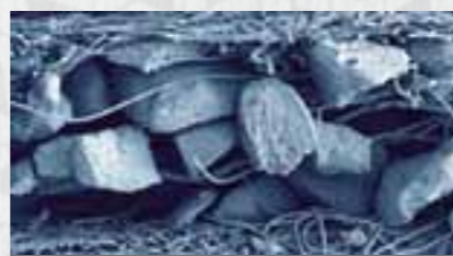
«Сэндвичевая» конструкция под растровым электронным микроскопом: комбинированный фильтр (LAK), состоящий из двух волоконных слоев и среднего слоя из активированного угля.
