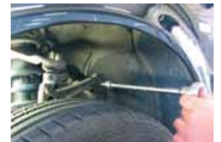
Затяжка зажимного винта на рычаге моста для фиксации шарнира тяг рулевой трапеции.
