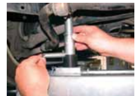
Позиционирование цилиндра балки V.A.G. 1925 на подрамнике переднего моста автомобиля.
