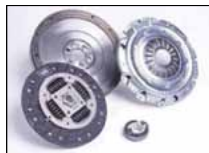
Valeo КИТ 4Р — комплект сцепления с жестким маховиком для замены двухмассовых систем сцепления
