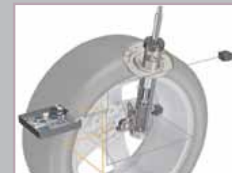
Электронно-регулируемые амортизаторы CDC (Continuous Damping Control) производства ZF Sachs надежно обеспечивают оптимальное усилие амортизации.
