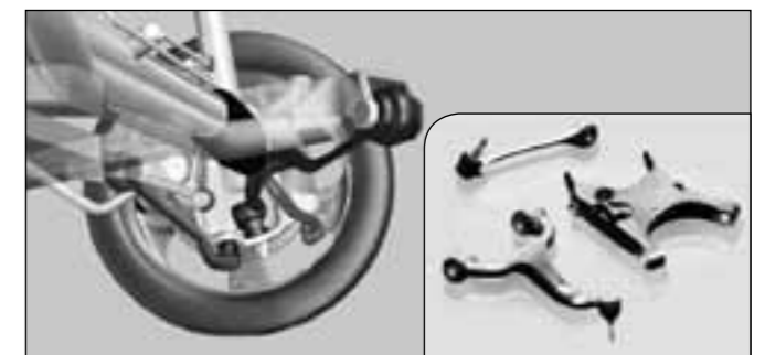
Поперечный рычаг подвески или рычаг независимой подвески колеса
