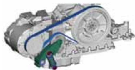
Система ременного привода двигателя внутреннего сгорания с автоматическим механизмом натяжения ремня.
